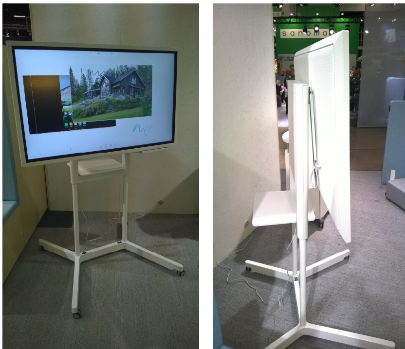
Kuva 10 - Esimerkki kevytrakenteisesta siirrettävästä näyttökäluusteesta, näytön koko 55", kokonaispaino n. 50 kg – tämän kokoinen näyttö sopii vain pieniin tiloihin.
